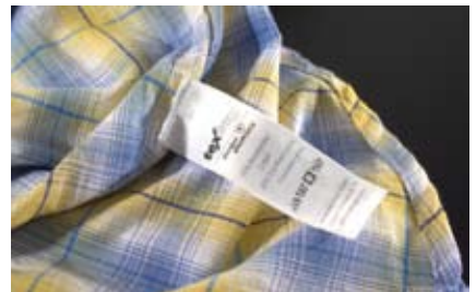
Textile UHF-Transponder für Supply-Chain und EAS
